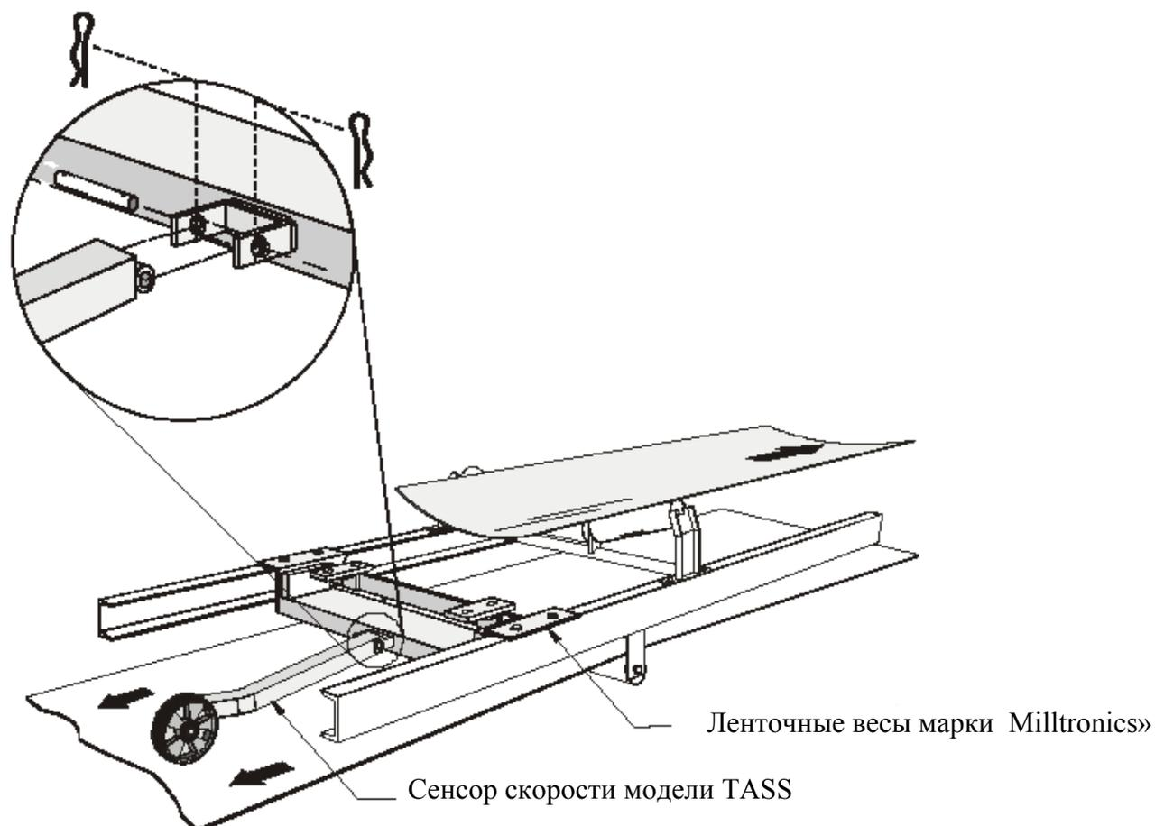
**Примечание:** обеспечить постоянное касание колесом ленты конвейера
