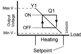
2 последовательности Обратного действия (Зависимый контур управления) (приложения: 20-29)
