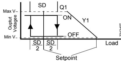
2 последовательности Обратного действия (Независимый контур управления) (приложения: 30-39)
