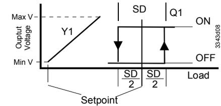
2 последовательности Прямого действия (Независимый контур управления) (приложения: 70-79)
