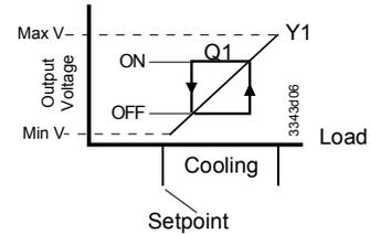
2 последовательности Прямого действия (Зависимый контур управления) (приложения: 60-69)
