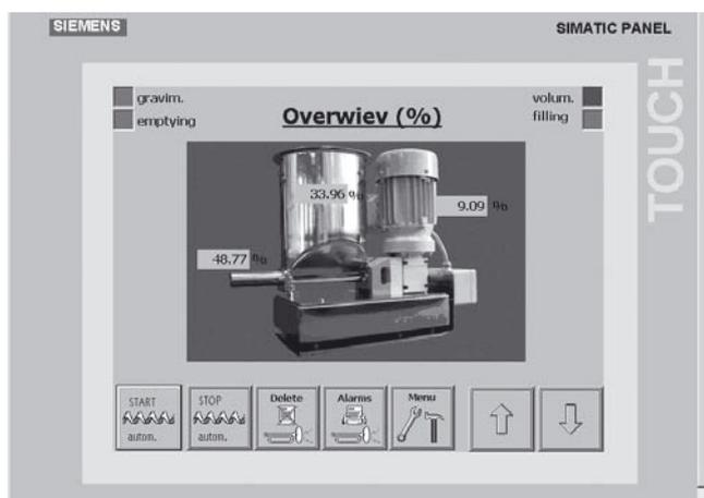
Вид весов дифференциального весового дозатора
