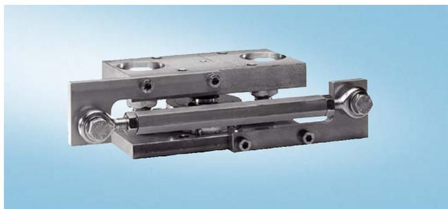
Соединение можно использовать в качестве дополнения к комбинированному монтажному блоку в весоизмерительных ячейках серии RN. Оно используется в том случае, если в ходе взвешивания возникают нежелательные горизонтальные силы, например, в резервуарных весах в процессе смешивания, или в конвейерных весах из-за ускорения взвешиваемого груза.
