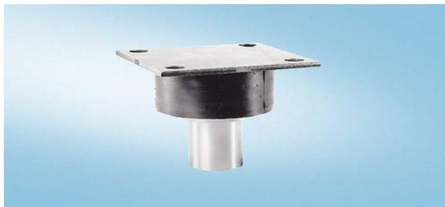
Самоцентрирующаяся эластомерная опора для весоизмерительных ячеек серии SB - это идеальный элемент распределения нагрузки для весов без соединений. Она гасит вибрацию и удары и используется в резервуарных и платформенных весах.
