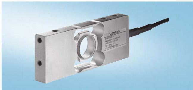
Весоизмерительная ячейка предназначена для небольших платформенных весов с одной ячейкой (размеры платформы не более 350 x 350 мм), а также для использования в торговых весах класса III с максимальным количеством делений  $n_{\max} = 3000$  d.
