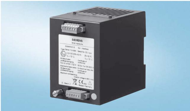
Взрывозащищенный интерфейс типа SIWAREX IS подходит для весоизмерительных модулей SIWAREX U, CS, MS, FTA, FTC, M и CF. Содержит 6 защитных барьеров и сертифицирован по ATEX и EN 5001U 2D/ II(2)G[EEx ib] IIC. Взрывозащищенный интерфейс монтируется вне взрывоопасной зоны. Размещается в распределительном шкафу, предпочтительно под весоизмерительной электроникой, крепится по стандарту EN 50022 с помощью 35-мм несущей шины.
