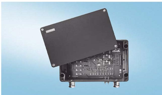
Взрывозащищенный интерфейс типа SIWAREX Pi подходит для весоизмерительных модулей SIWAREX U, CS, MS, FTA, FTC и M. Он содержит 6 защитных барьеров и имеет допуск FM для приборов Class I Div.1. Взрывозащищенный интерфейс монтируется вне взрывоопасной зоны.
