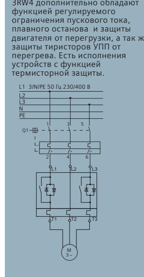
Устройства плавного пуска 3RW4
