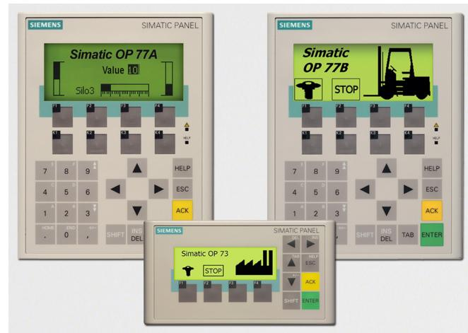
Проекты, созданные для OP 3 и OP 7 в среде ProTool/Lite, ProTool или ProTool/Pro, могут конвертироваться в проекты SIMATIC WinCC flexible для использования в панелях SIMATIC OP 73 и OP 77A соответственно.
