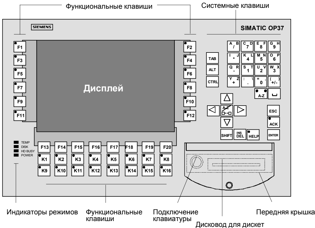
Рис. 17-1. Расположение элементов управления и индикации
