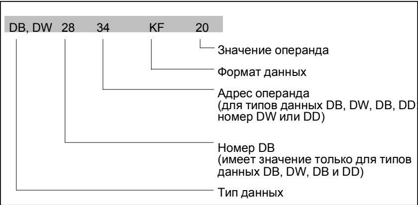
Рис. 10-2. Представление операндов контроллера для SIMATIC S5
