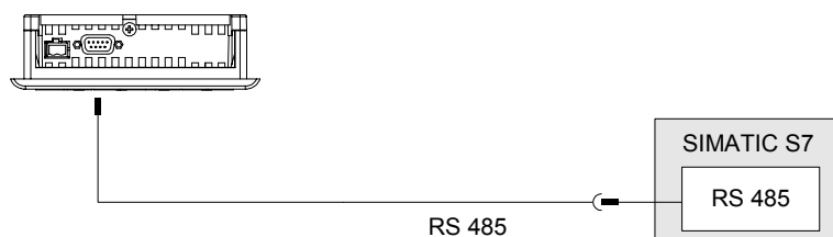
Рисунок 4-15 Подключение ПЛК к OP 77A
