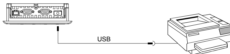
Рисунок 4-19 Подключение принтера к OP 77B
