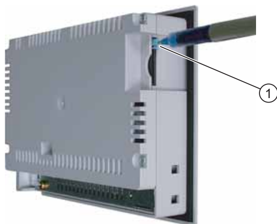
Рисунок 5-4 Извлечение карты памяти на примере TP 177B
