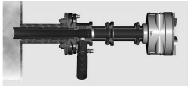
Усиленная продувка на стороне процесса, с соединительным адаптером для шланга
