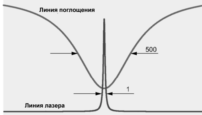
Типичная спектральная ширина линии поглощения в сравнении с шириной полосы лазерного света.
