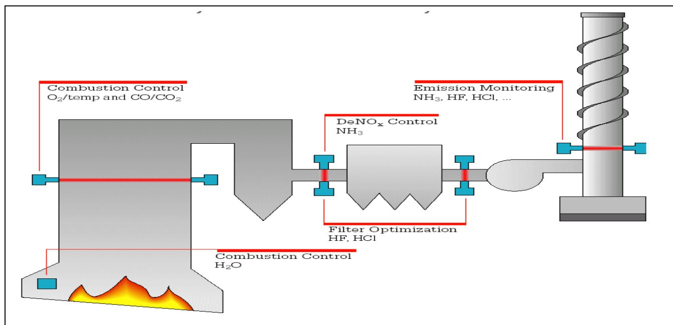
**Стандартные применения****Мониторинг работы скрубберов и фильтров по содержанию хлористого водорода**
