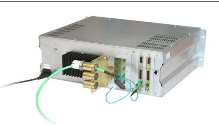
Подключение сенсоров к преобразователю производится с помощью оптоволоконного кабеля. Максимальная длина кабеля может составлять до 1000 м. К одному преобразователю может быть подключено до 3х сенсоров. Преобразователь имеет стандартный 19-дюймовый корпус, предназначенный для щитового монтажа.
