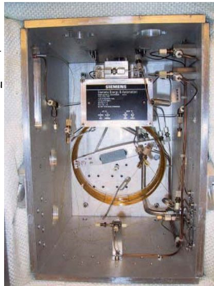
Рис. 6: Стандартный анализатор бензина, конфигурация термостата
