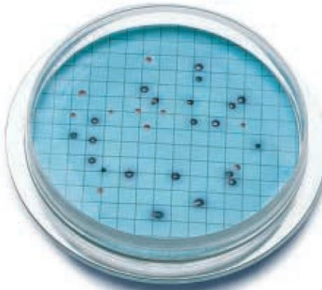
Готовая мембранный фильтрация с M COLI BLUE24: надежное определение *E. coli* и колиформных бактерий всего за 24 ч!
