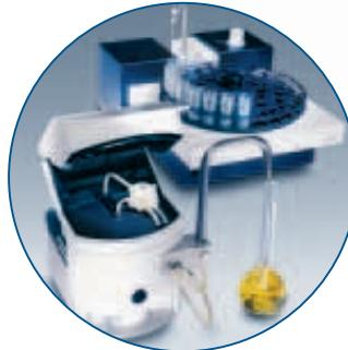
Модуль со встроенным насосом для анализа серий образцов с различными проточными кюветами
