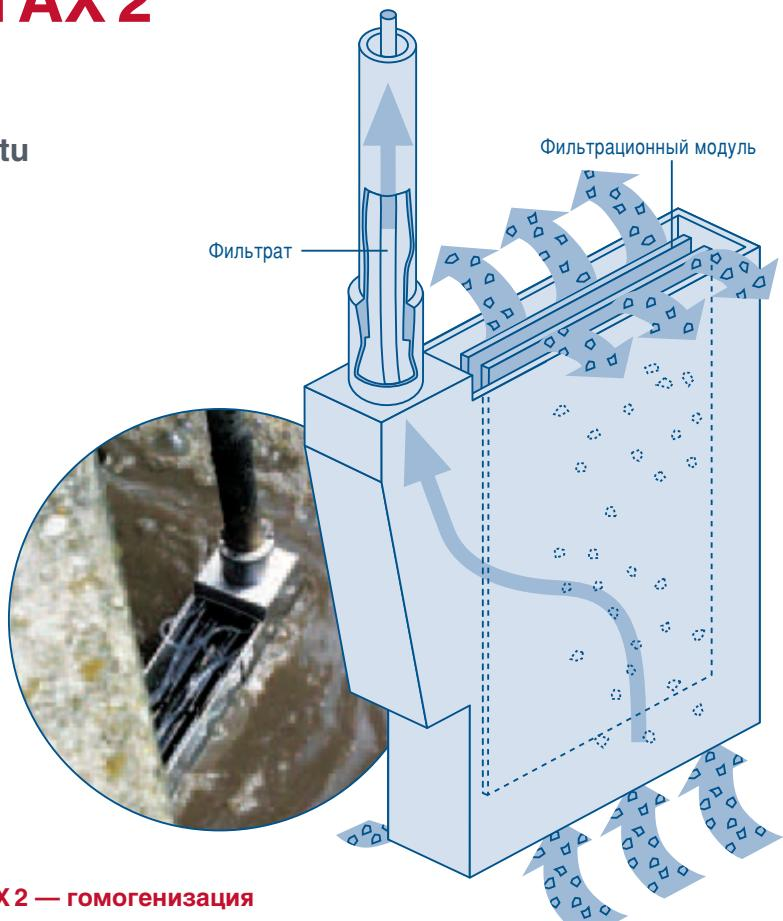
Фильтрация пробы с помощью FILTRAX
