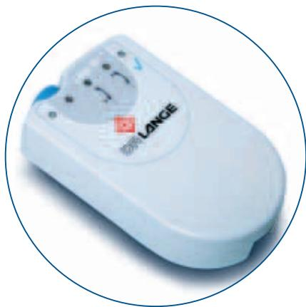
Адаптер для обновления методик и программ прибора при помощи телефона
