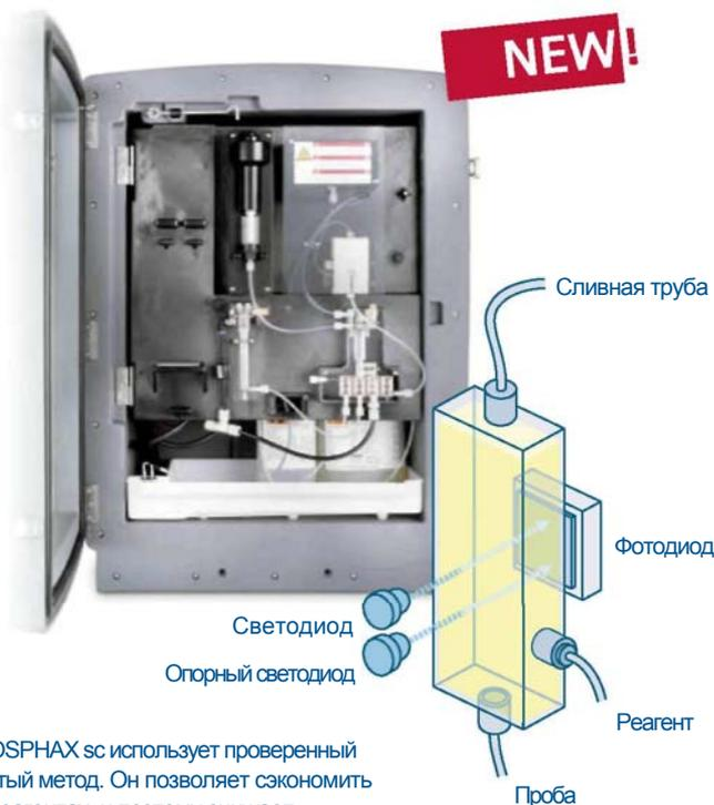
PHOSPHAX sc использует проверенный желтый метод. Он позволяет сэкономить на реагентах, и поэтому снижает стоимость эксплуатации.
