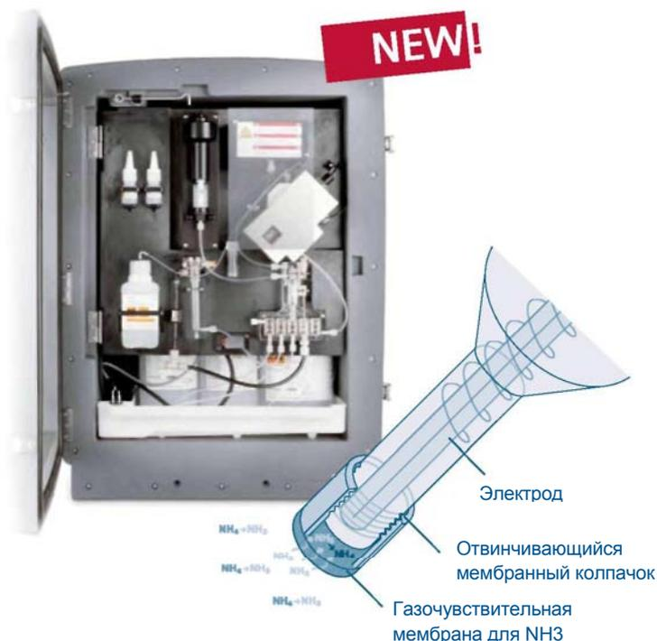
AMTAX sc использует газочувствительный электрод (GSE). Для замены накручивающегося мембранного колпачка и электролита требуется всего несколько минут.
