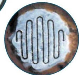
Установка in-situ в жидкость означает отсутствие транспортировки пробы, снижая таким образом возможность помех. Специальная ионная мембрана позволяет выполнять не подверженные помехам ISO-совместимые измерения с минимальными эксплуатационными затратами.
