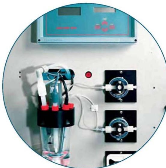
Аналитический модуль анализатора 8810 с автоматической чисткой электродов
