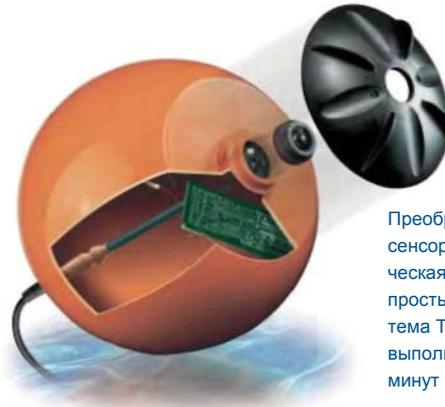
Преобразователь OXY 4100 с сенсором OXY 1100; автоматическая калибровка выполняется простым наклоном датчика (система TILTCAL), и ее необходимо выполнять лишь в течение пяти минут три раза каждый год.
