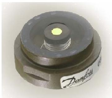
**Сенсор** представляет собой датчик Кларка с высоким ресурсом работы и минимальным влиянием загрязнений на характеристику мембраны. Золотой электрод (катод) обеспечивает высокую стабильность нуля, а серебряный (анод) – широкий диапазон измерений
