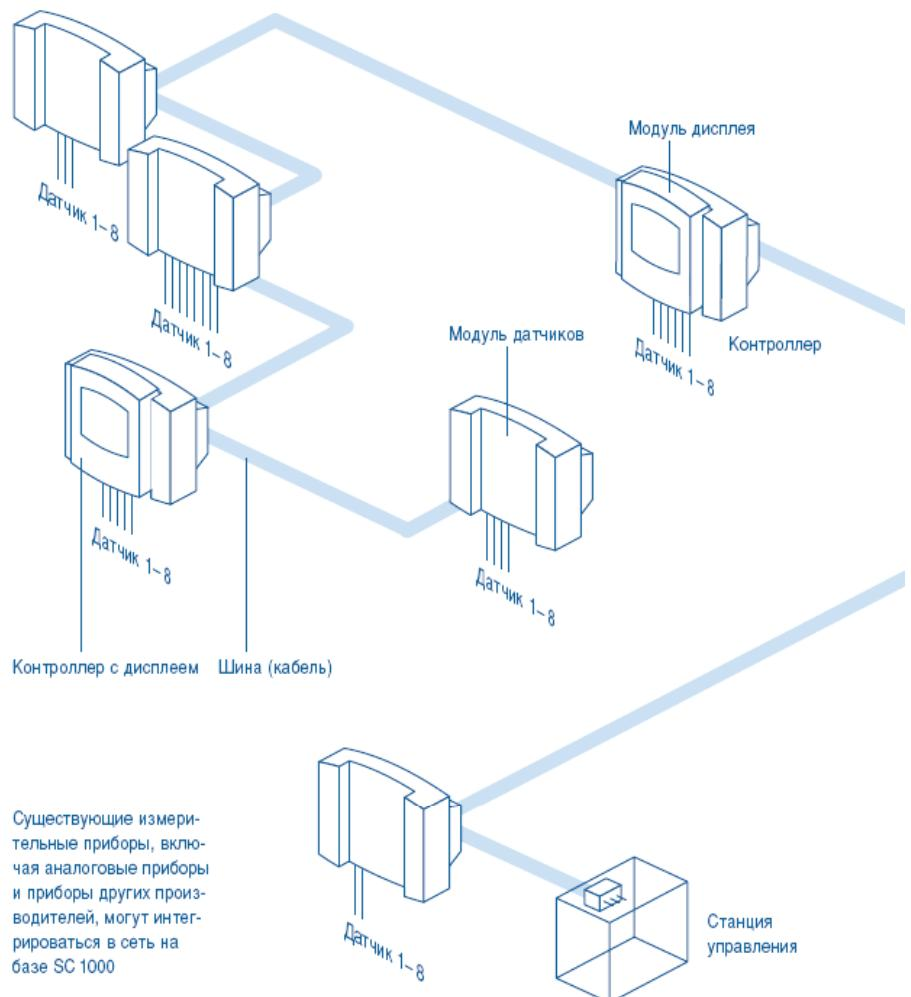
Существующие измерительные приборы, включая аналоговые приборы и приборы других производителей, могут интегрироваться в сеть на базе SC 1000
