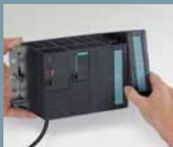
Вставьте SIFLOW FC070 в несущую шину SIMATIC
