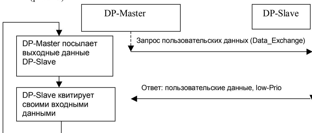
**Рис. 2.5** Циклический обмен пользовательскими данными DP-Slave с DP-Master'ом
