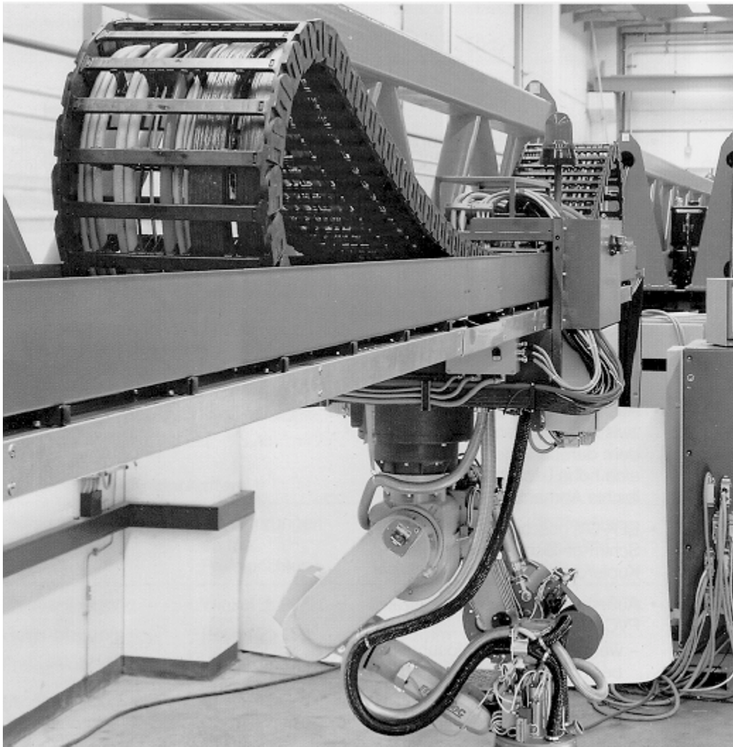
Рисунок 7-7 Пример использования стеклянного волоконно-оптического кабеля для подвижных механизмов в волочащемся шлейфе
