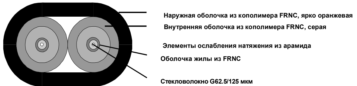
Рисунок 7-5 Структура волоконно-оптического кабеля INDOOR
