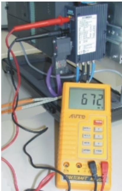
Рисунок А-6 Определение качества сигнала в модуле OLM V3 с помощью вольтметра
