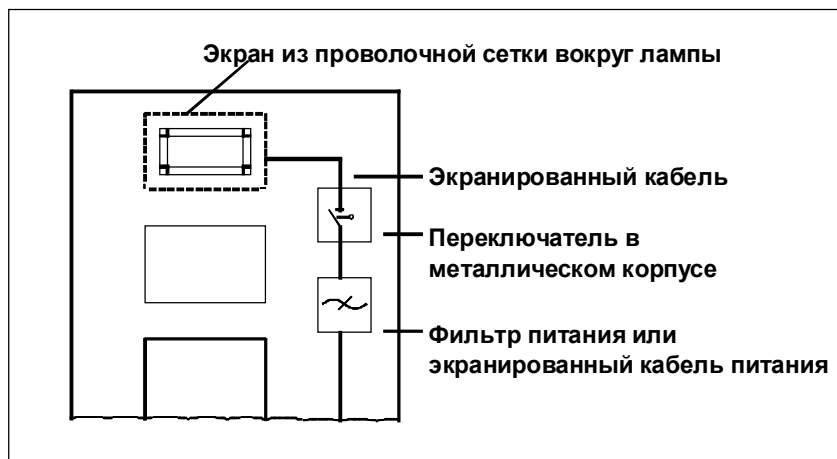
Рисунок-С5 Меры по подавлению помех от ламп дневного света в шкафу
