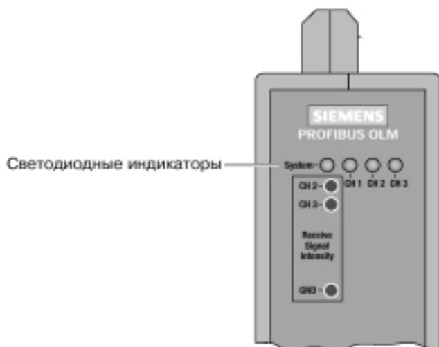
Рис. 14: Светодиодные индикаторы на передней панели
