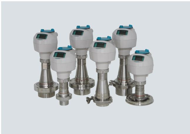
SITRANS LR250 с инкапсулированной гигиенической антенной - это 2-проводной 25 ГГц импульсный радарный измерительный преобразователь с санитарно-гигиеническими разрешениями для непрерывного измерения уровня жидкостей, взвесей и паст в пищевой, химической и фармацевтической промышленности, в диапазоне до 20 м - в зависимости от антенны.
