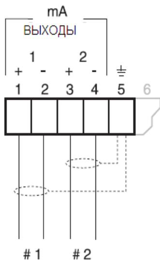
0/4-20 mA изолированный выход до 750Ω макс.
