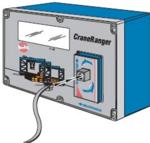
Модуль ComVerter вставляется в стыковочный отсек аналогично ручному программатору и обеспечивает связь с персональным компьютером с программой Dolphin Plus (поставляется отдельно).
