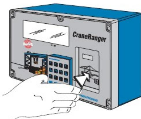
Ручной программатор вставляется в стыковочный отсек и удерживается в нём при помощи магнита.
