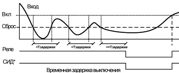
\*Временная задержка не влияет на СИД, когда выбран **ручной** или **автоматический** режим сброса. Работа СИД повторяет срабатывание точек включения и сброса.
