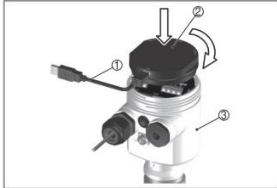
Рис. 33: Подключение ПК через интерфейсный адаптер прямо к датчику
