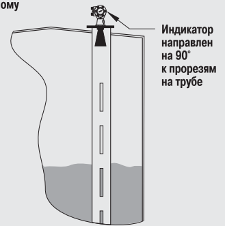
Монтаж на измерительной трубе
