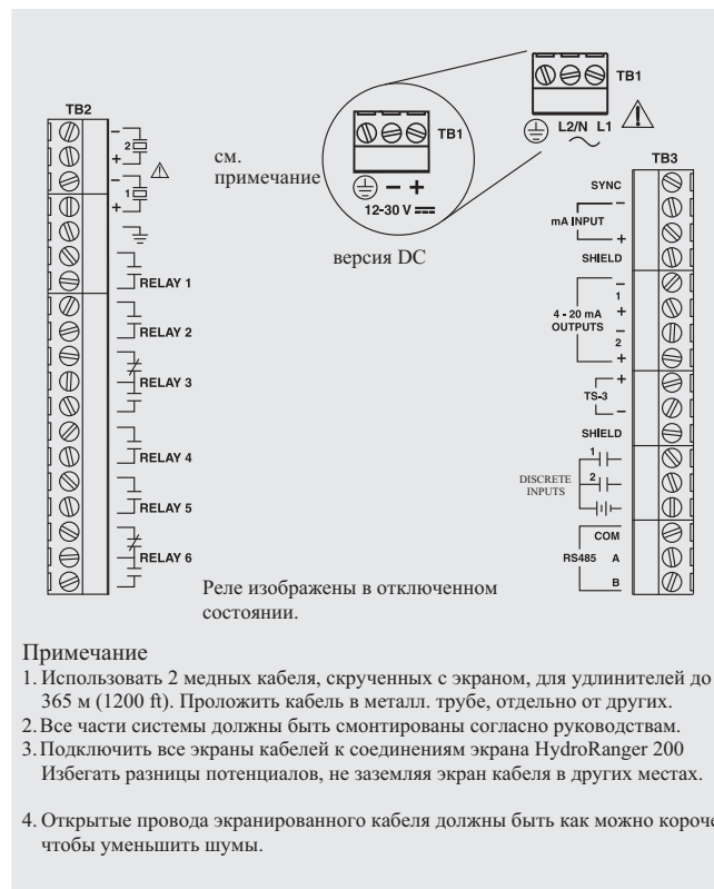
HydroRanger 200, схема соединения
