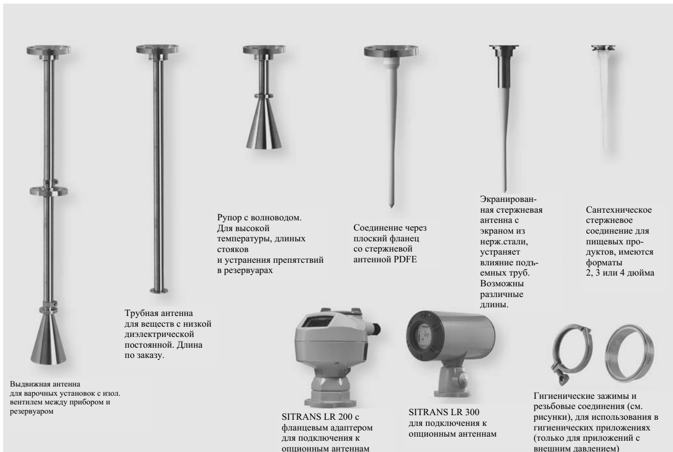
Конфигурации антенн для SITRANS LR 200 и LR 300
