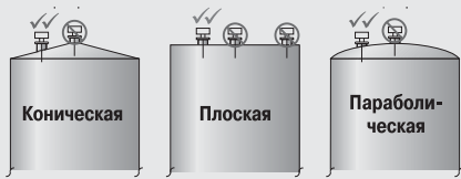
Монтаж на ёмкости
