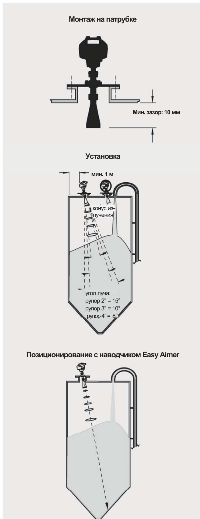
Установка SITRANS LR260
