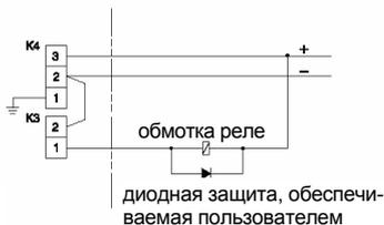
Нагрузка переключателя: 250 V AC, 100 мА макс., 2 VA/2 Вт макс.
