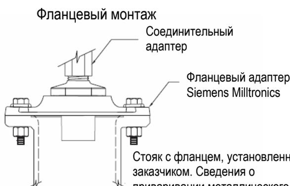
Стояк с фланцем, установленным заказчиком. Сведения о приваривании металлического фланца к трубе Вы найдете в *Руководстве по применению ультразвуковых датчиков*, которое Вы можете загрузить с нашего веб-сайта:
