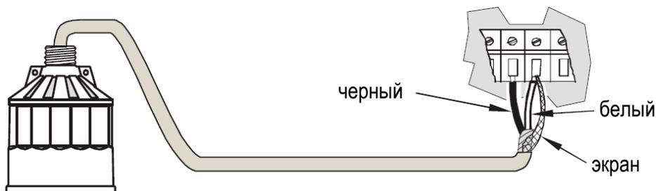
**Указание:** При подключении EnviroRanger ERS 500, MultiRanger 100/200 или HydroRanger 200 белый и черный провода и экран подключаются отдельно. Экран и белый провод НЕ ДОЛЖНЫ быть соединены.
