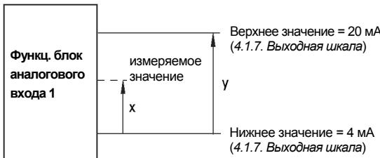
$$\text{mA-значение OUT} = \frac{x}{y} \times 16 \text{ mA} + 4$$
