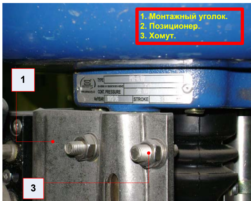
Рис. Установка позиционера с помощью полного монтажного комплекта на плоскую стойку.
