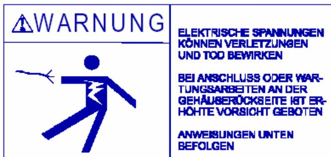
Данное указание по безопасности обращает Ваше внимание на **ВОЗНИКНОВЕНИЕ ОПАСНЫХ НАПРЯЖЕНИЙ** на соединительных клеммах, находящихся на **ЗАДНЕЙ СТОРОНЕ КОРПУСА** Вашего устройства. **СОБЛЮДАТЬ ОСОБУЮ ОСТОРОЖНОСТЬ ПРИ ЭЛЕКТРОМОНТАЖЕ И ОБСЛУЖИВАНИИ ВАШЕГО ПРИБОРА.**
