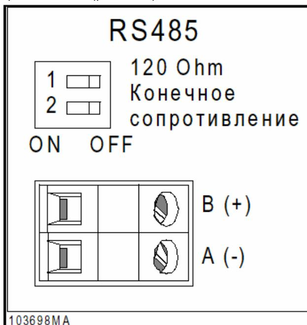
Рис. 2-12 RS485-расширение интерфейсов
