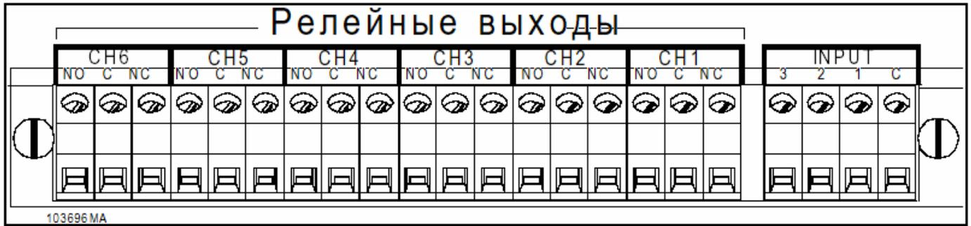
Рис. 2-10 Блок подключения цифрового входа/выхода
