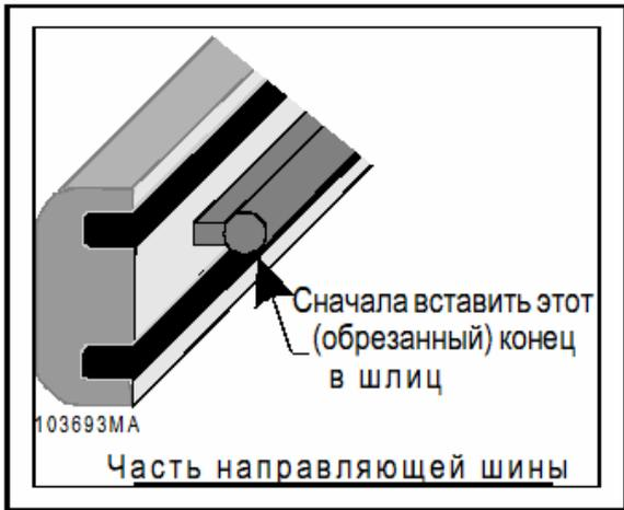
Рис. 2-3А Направляющая шина, часть
