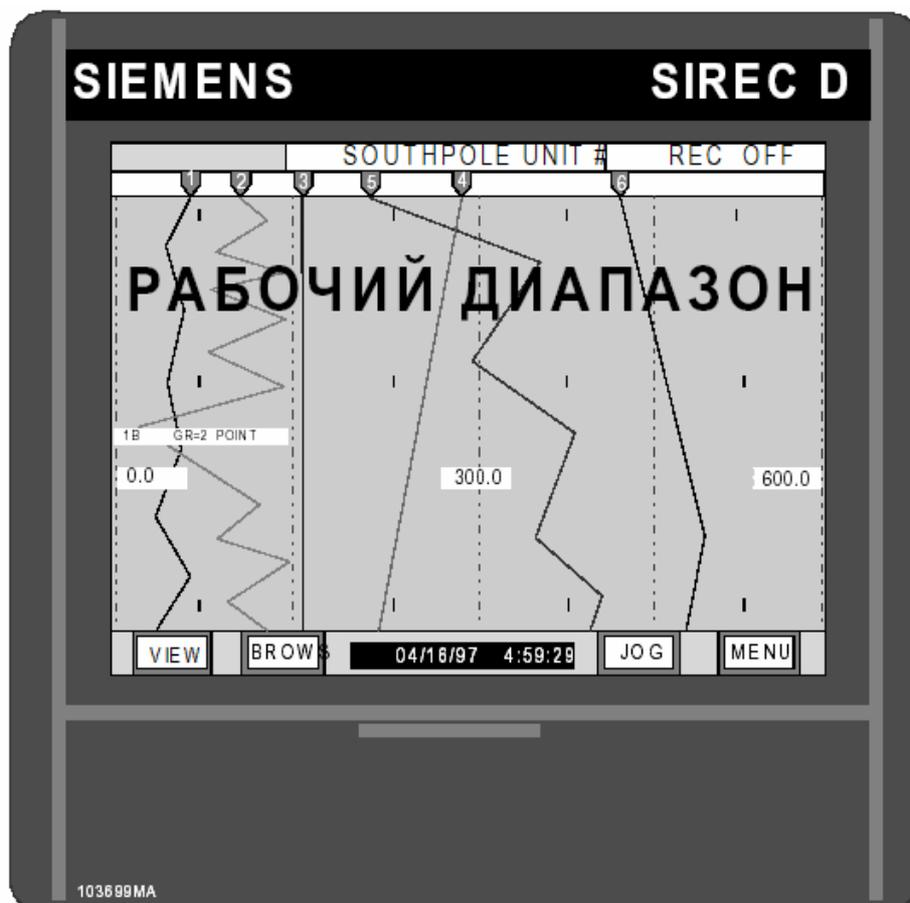
Рис. 1-1 Цифровой регистратор SIREC D вид спереди
