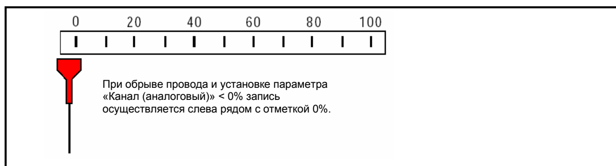
Рисунок 4.5-11 Пример индикации обрыва провода прибором L/LA
