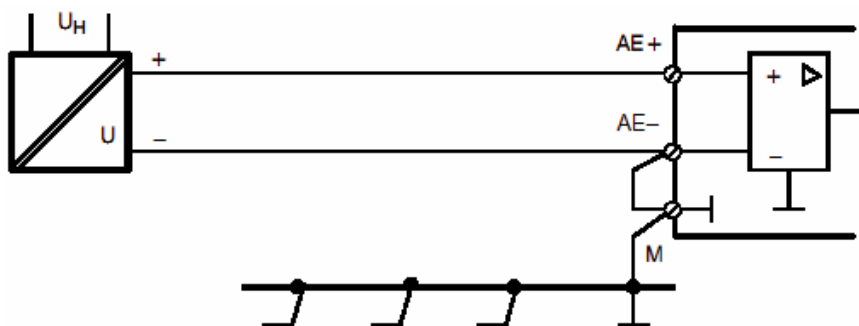
Рис. 2-34 Подключение источника напряжения с разделением потенциалов
