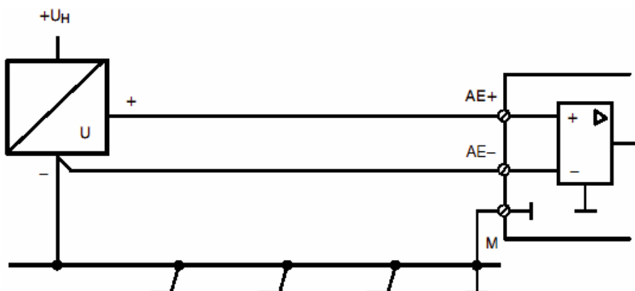
Рис. 2-37 Подключение соединенного потенциалами источника напряжения, относящего +полюсом к М, с двухполюсным соединением
