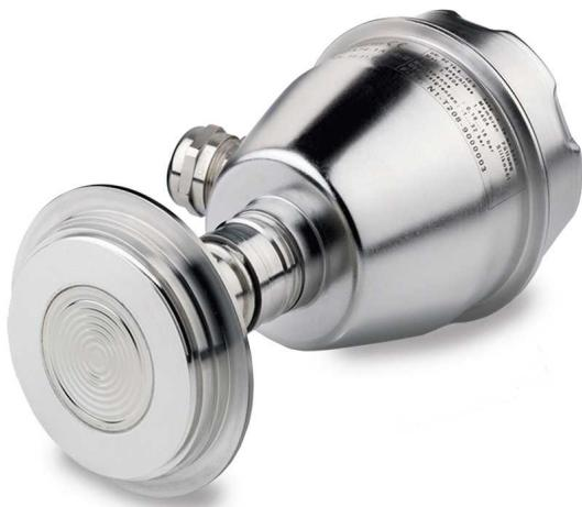
SITRANS P300 обеспечивает установку в процесс без образования «мертвых зон», благодаря множеству вариантов гигиенических исполнений. Также прибор имеет одобрения EHEDG и ЗА, подтверждающие пре- восходное качество поверхности (шероховатость  $\leq 0.8 \mu\text{m}$ ). Наполнительное масло соответствует требо- ваниям FDA.
