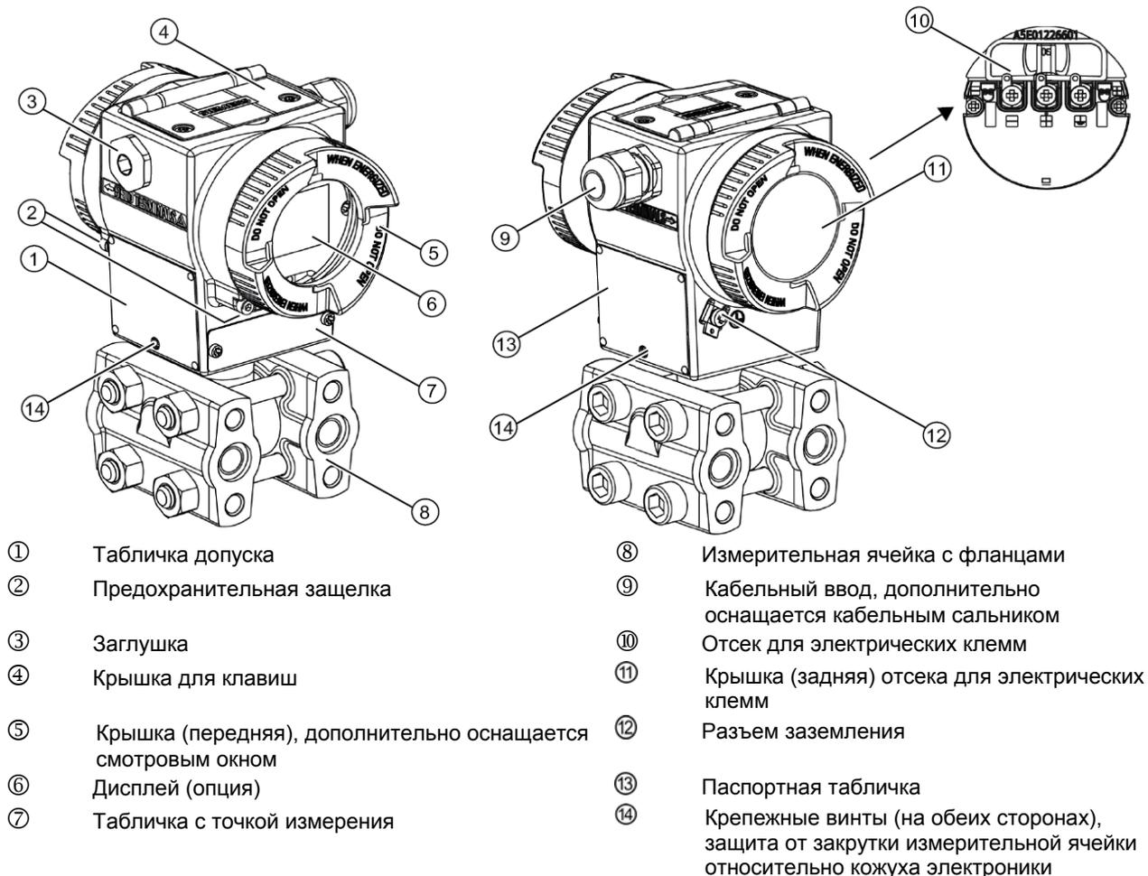
Рисунок 3-2 Общий вид датчика
