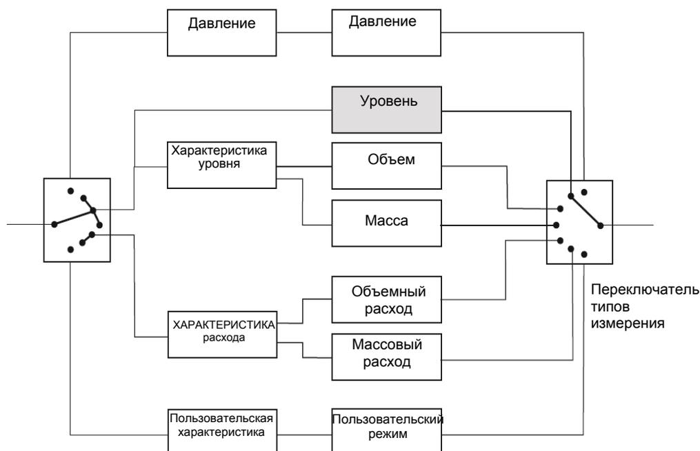
Рисунок 6-6 Тип измерения «Уровень»
