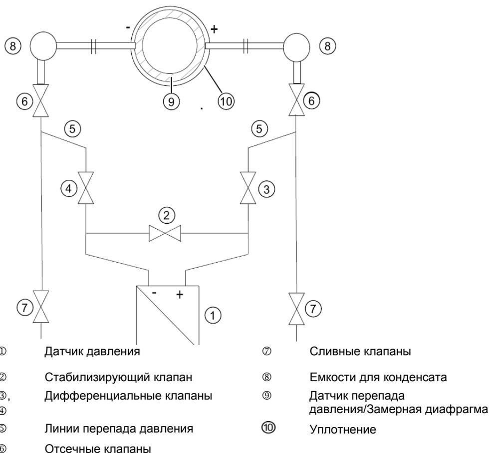
Рисунок 7-1 Измерение пара
