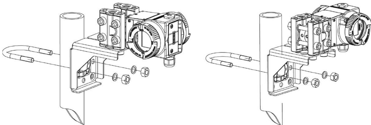
Рисунок 4-2 Крепление датчика на монтажную скобу с вертикальными линиями перепада давления
