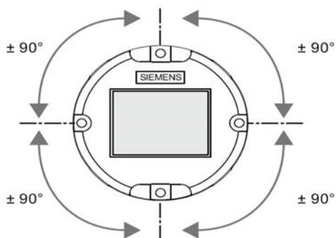
4. Установить дисплей и закрепить его двумя винтами.
