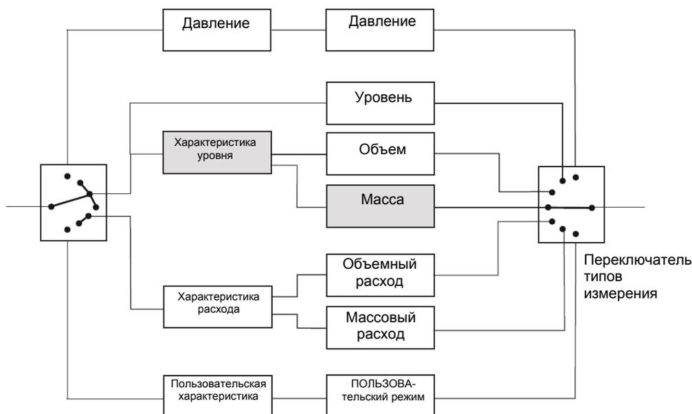
Рисунок 6-9 Тип измерения «Масса»
