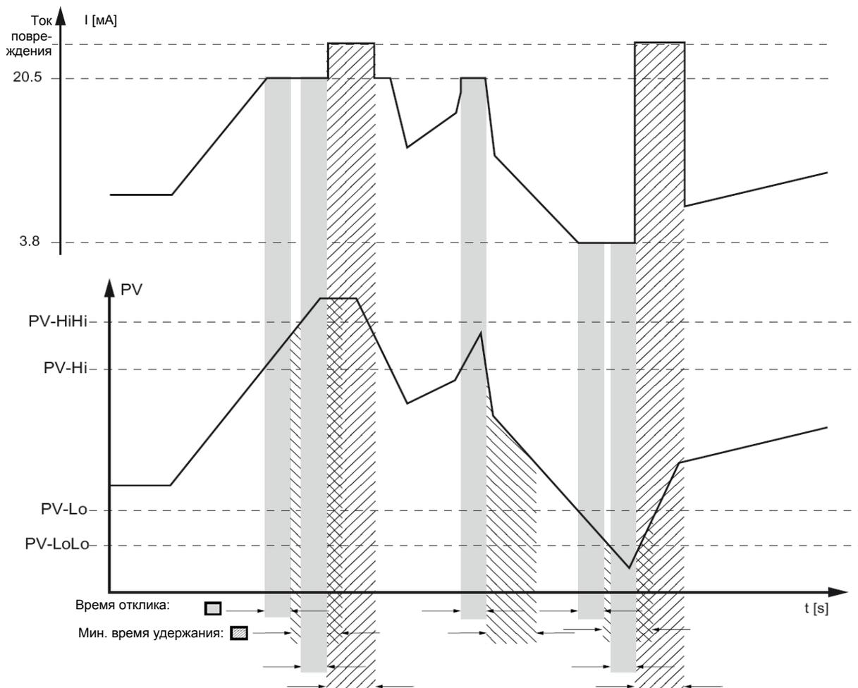
Рисунок 6-21 Границы срабатывания указателя предельного значения
