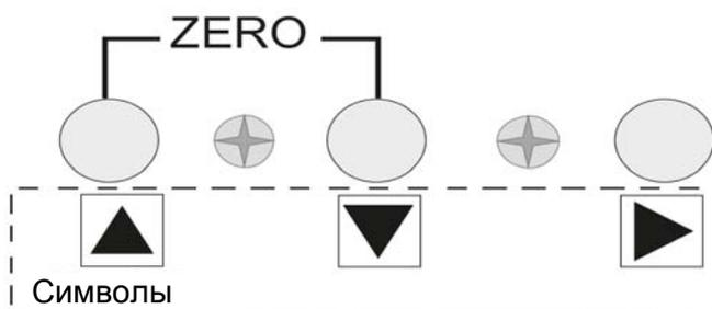
Символ «ZERO» указывает, какие клавиши нужно нажать для установки на нуль. Удерживать нажатыми обе кнопки, пока не произойдет установка.
