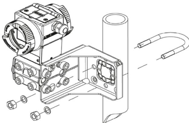
Рисунок 4-1 Крепление датчика на монтажную скобу с горизонтальными линиями перепада давления
