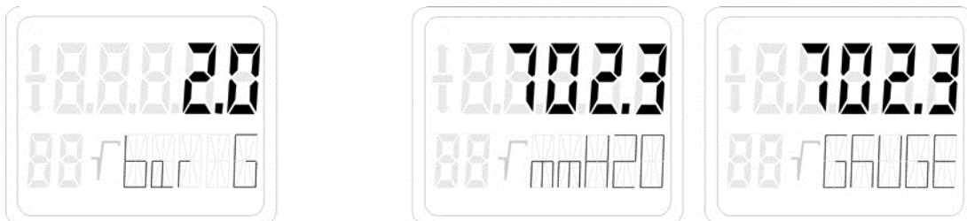
Рис. 7-13 Пример дополнения с избыточным давлением (GAUGE)
