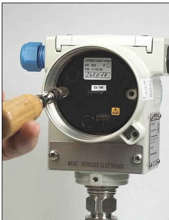
Рис. 22 Затяжка резьбовых болтов для крепления электроники
