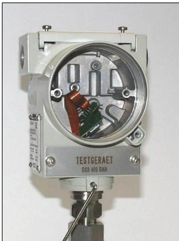
Рис. 28 Ослабление крепежного винта с помощью шестигранного гаечного ключа
