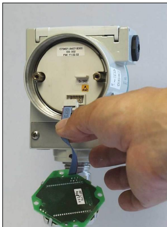
Рис. 7 Вытяните ЖК-дисплей до продукта версии 29
