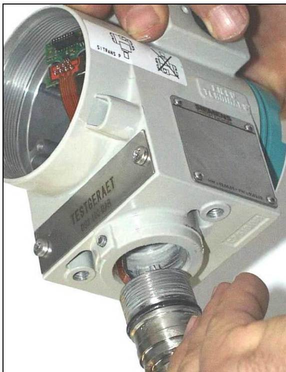
Рис. 32 Установка измерительной ячейки
