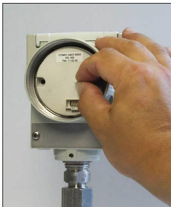
Рис. 9 Выньте электронный блок
