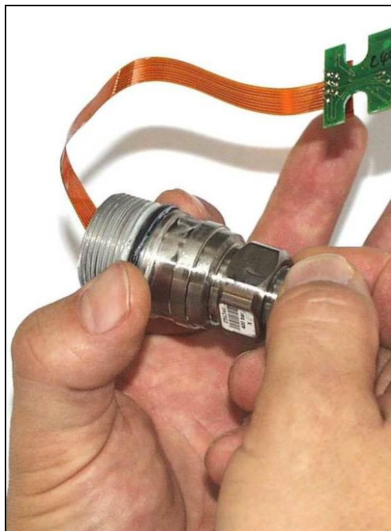
Рис. 31 Измерительная ячейка с уплотнительным кольцом
