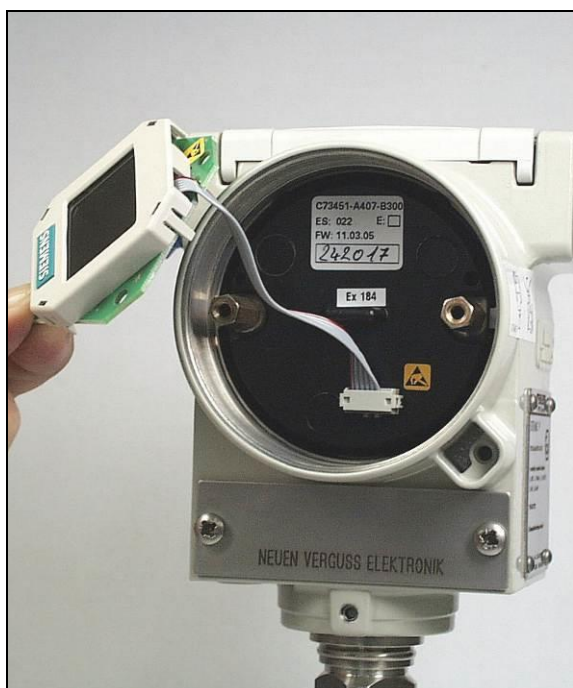
Рис. 8 Вытяните ЖК-дисплей как продукт версии 30
