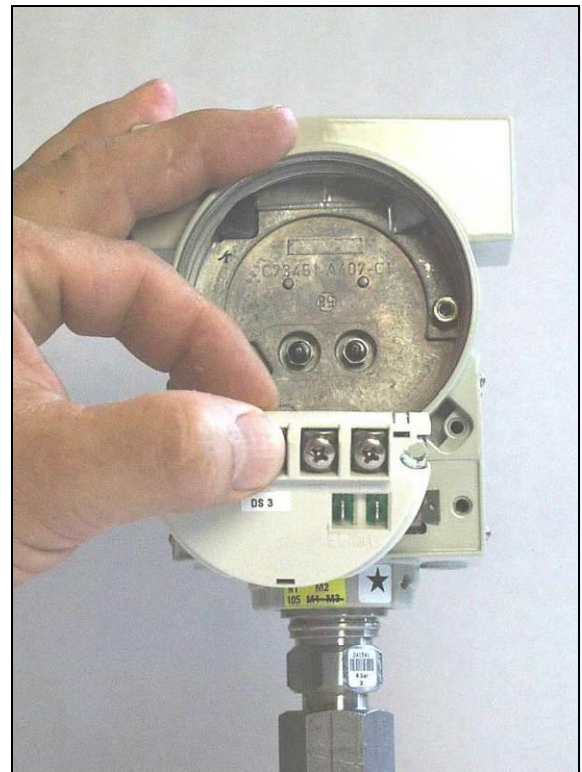
Рис. 26 Извлеченная соединительная плата с проходными штырями позади нее
