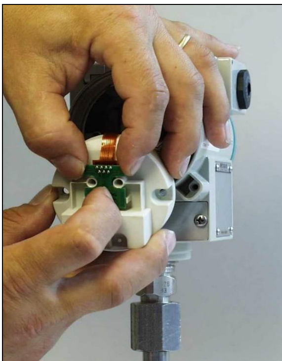
Рис. 16 Положите панель измерительной ячейки
