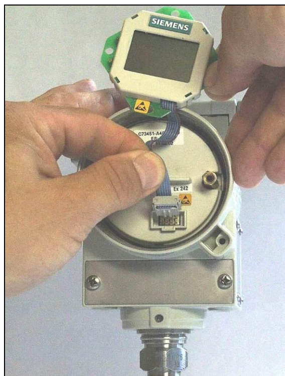
Рис. 23 Правильное подключение дисплея
