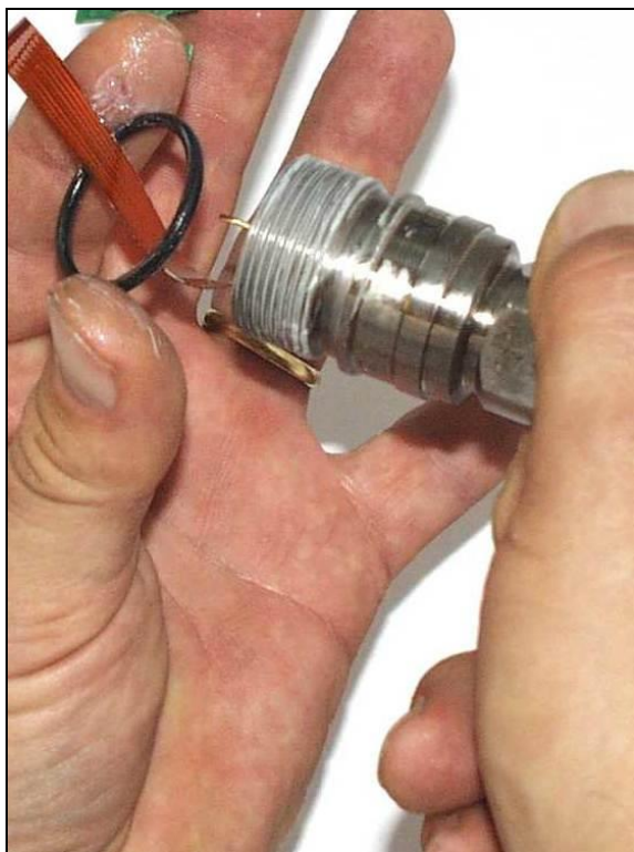
Рис. 30 Установка уплотнительного кольца на измерительную ячейку
