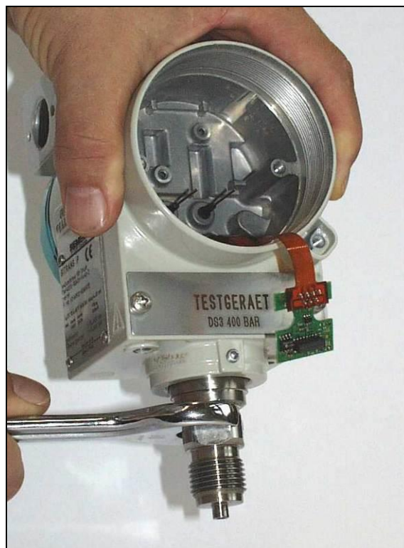
Рис. 29 Ослабление ячейки с помощью вильчатого гаечного ключа
