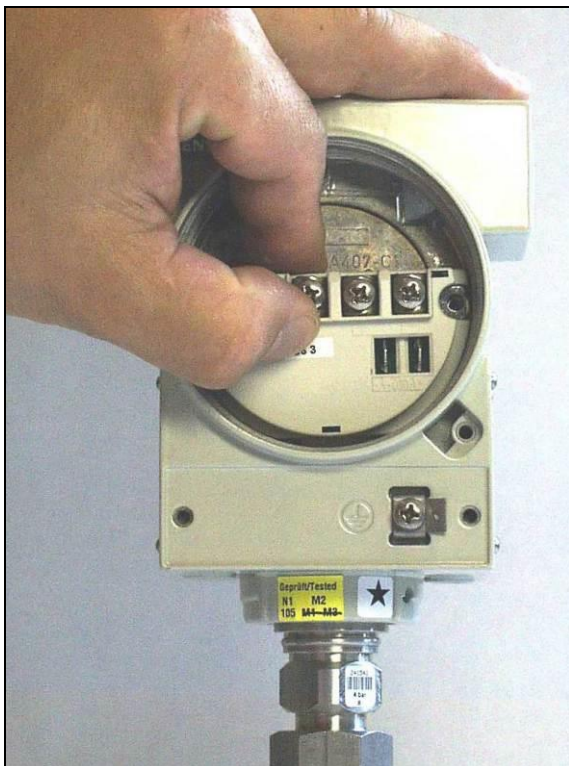
Рис. 27 Вставьте на место соединительную плату
