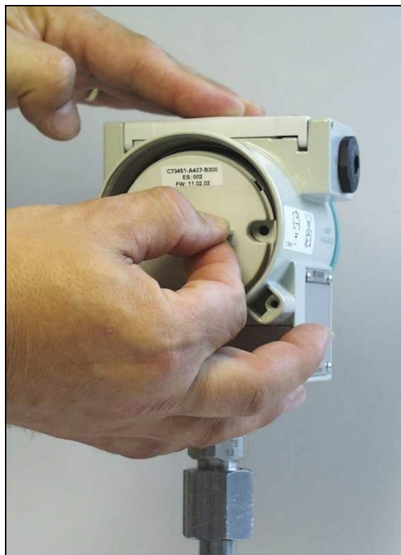
Рис. 19 Вставьте корпус электроники
