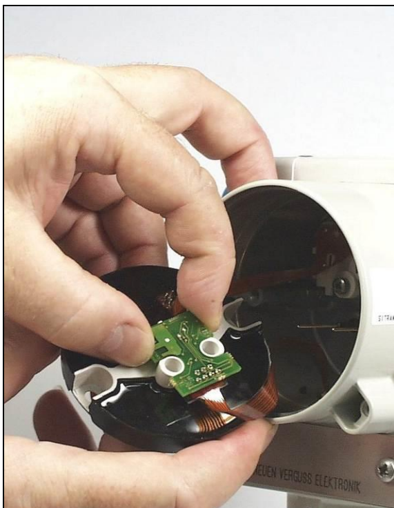
Рис. 14 Вытяните панель измерительной ячейки с помощью соответствующего инструмента, например парой пинцетов, как описано для продукта до 30 версии
