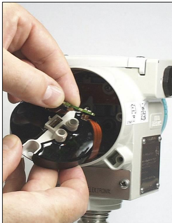
Рис. 21 Установка панели измерительной ячейки для продукта версии 30
