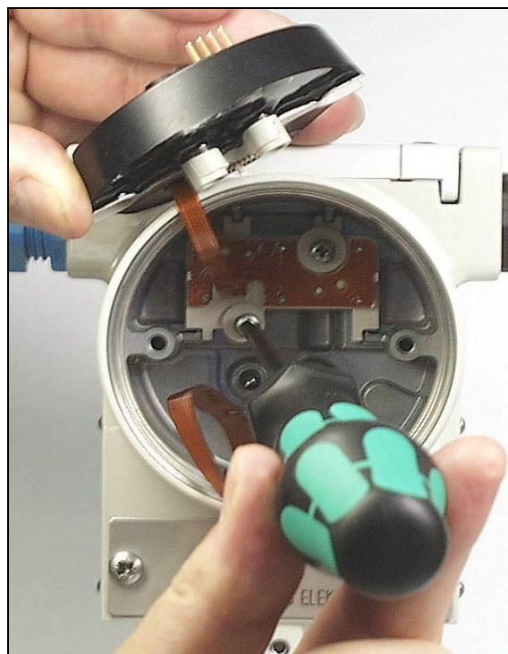
Рис. 17 Ослабьте или затяните клавиатуру печатной платы от/к нижней части корпуса для версии продукта 30
