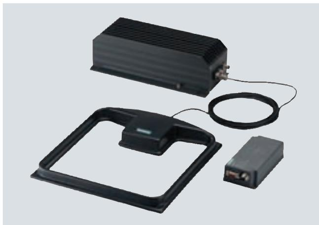
Устройство чтения/записи (SLG) предназначено для обеспечения индуктивной связи и подачи энергии на MDS, а также для подключения через последовательные порты (RS232 или RS422) к различным системам (ПК, ПЛК).
