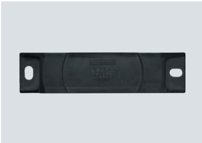
z аропрочный транспондер является пассивным и необслуживаемым на базе технологии UHF EPC Class 1 Gen2 для сохранения «электронного кода продукта» («Electronic Product Code» (EPC)) объемом 96/240 бит. Дополнительно у накопителя данных есть пользовательская память объемом 64 байта. Этот транспондер рассчитан на диапазон частот от 868 МГц (Европа) до 928 МГц (США)
