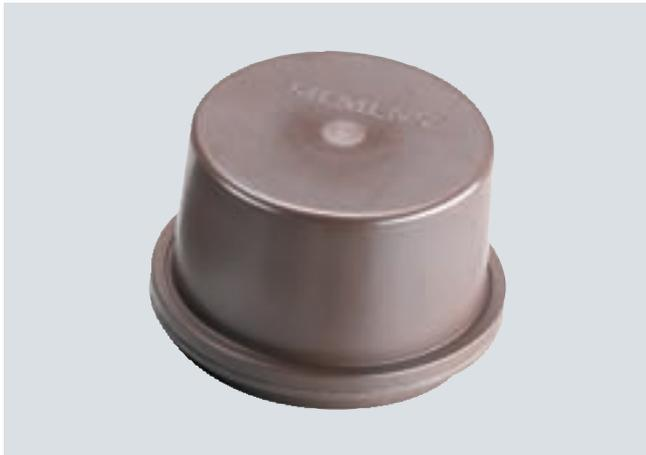
Термостойкий и прочный накопитель данных для применения в лакировочных цехах (автомобильная промышленность, грунтовочный/покровный лак) или областях с аналогичными требованиями к температуре, емкость памяти 32 Кбайт ОЗУ, температурный диапазон от -25°C ... + 85°C до +220°C циклично, класс защиты IP68, размер корпуса (мм) Ø 114 x 83
