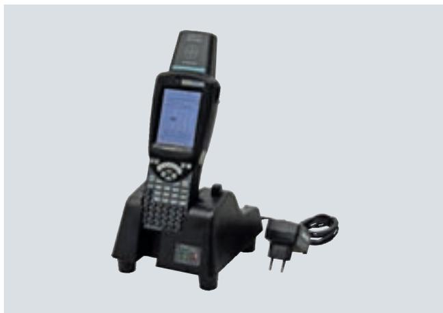
SIMATIC RF310M с зарядным/расширительным устройством
