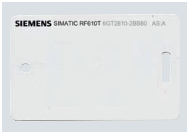
Транспондер SIMATIC RF610T является пассивным и необслуживаемым на базе технологии UHF EPC Class 1 Gen2 для сохранения «электронного кода продукта» («Electronic Product Code» (EPC)) в объеме 96/240 бит. Дополнительно у транспондера есть пользовательская память объемом 64 байта.
