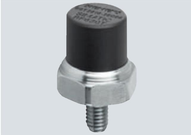
Транспондер является пассивным и необслуживаемым на базе технологии UHF EPC Class 1 Gen2 для сохранения «электронного кода продукта» («Electronic Product Code» (EPC)) в объеме 96/240 бит. Дополнительно в носителе данных есть пользовательская память объемом 64 байта. Этот транспондер выпускается на две частоты: 868 МГц (Европа) и 915 МГц (США).
