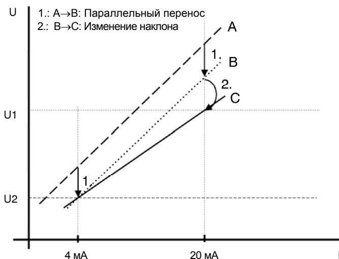
Рис. 14 Калибровка датчика тока: Пример для выхода 4-20 мА
