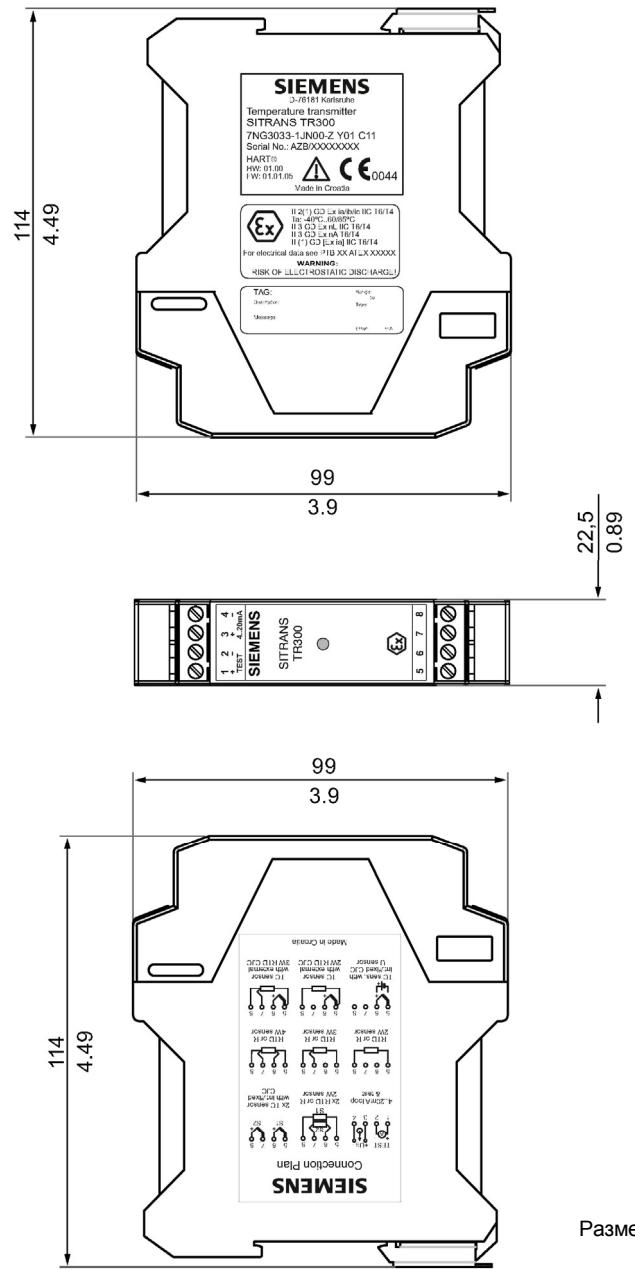
Размеры указаны в:  $\frac{\text{мм}}{\text{дюймах}}$
