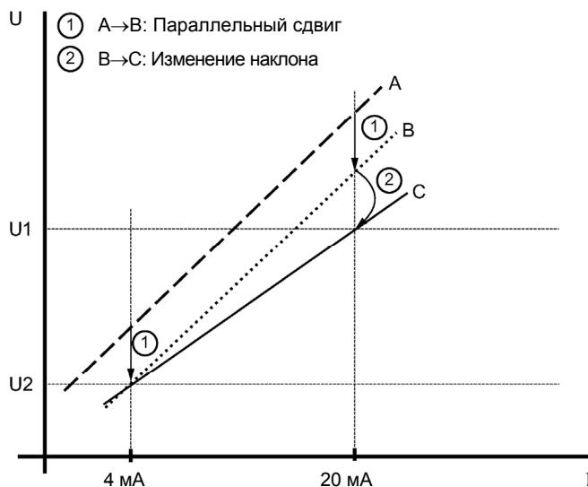
Рисунок 8-3 Калибровка датчика тока: Пример выхода 4-20 mA
