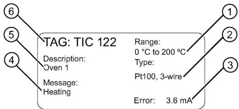
Рисунок 3-4 Пример заполненной таблички заказчика
