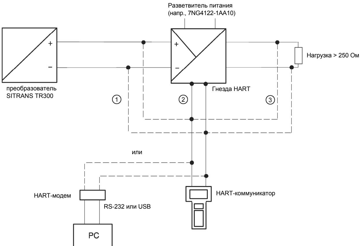
Рисунок 3-7 HART-коммуникации с питанием от разветвителя питания
