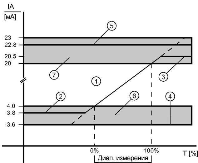
Рисунок 8-1 Пределы тока для выходного сигнала 4-20 mA
