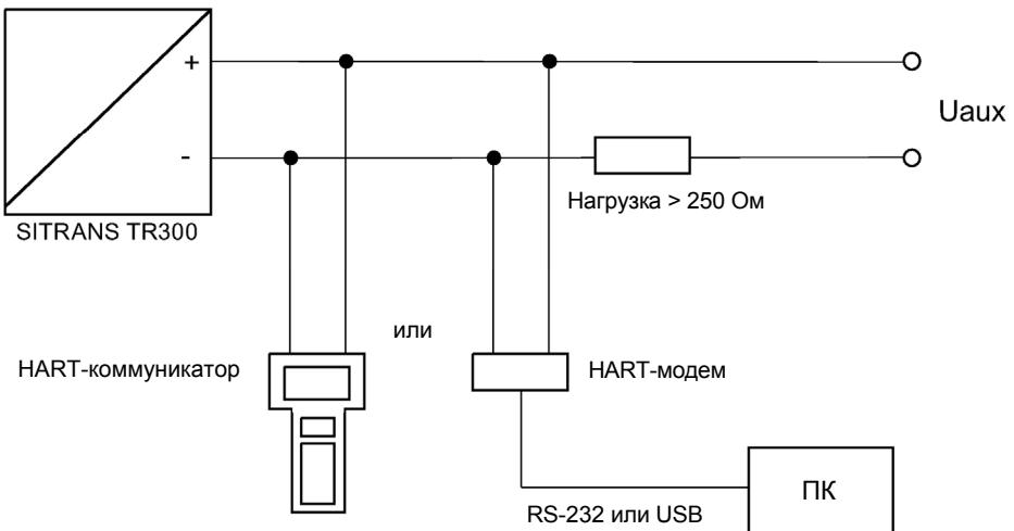
Рисунок 3-6 HART-коммуникации с питанием от источника напряжения
