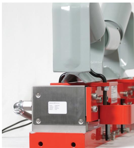
Рисунок 3: Фронтальное крепление весоизмерительной ячейки MSI снижает накопление отложений материала и увеличивает жесткость по всей ширине конвейера.
