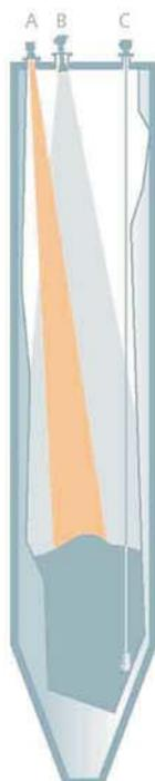
SITRANS LR560 (A) имеет острый луч при сравнении с другими транзиттерами этой категории (B). Сигнал TDR (C) проводится кабелем для специального измерения, когда материал касается кабеля.
