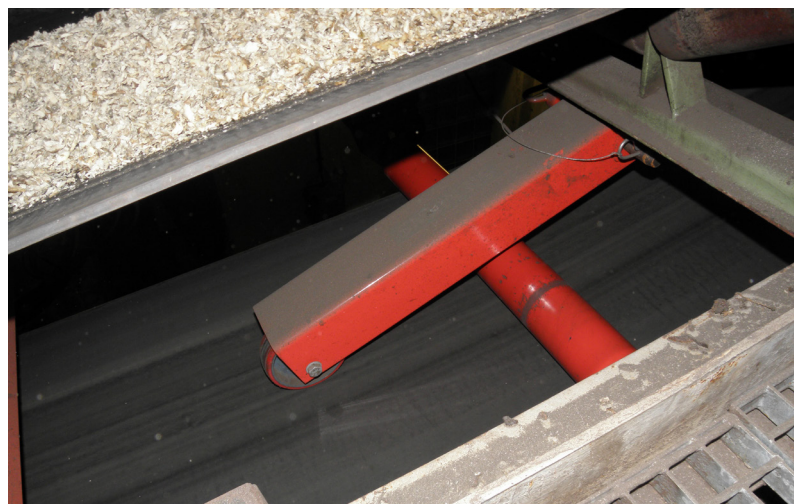
Датчик скорости Siemens Milltronics RBSS на обратной ветви ленты следит за скоростью конвейерной ленты и выдает сигнал в интегратор
