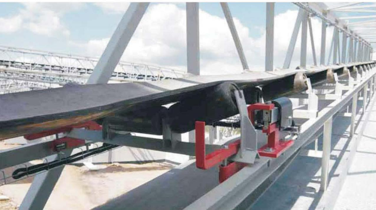
Классическая система взвешивания на ленточном конвейере состоит из платформенных весов, стоящих на тензодатчиках, интегратора и датчика скорости. Siemens предлагает полный ассортимент продукции с передовыми характеристиками для применения в любой области. Siemens также предлагает широкий выбор калибровочных принадлежностей и периферийных устройств.
