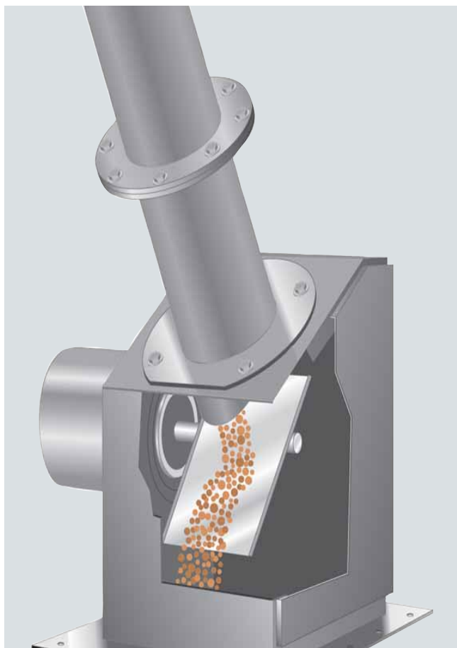
Расходомер сыпучих материалов с показанной чувствительной пластиной
