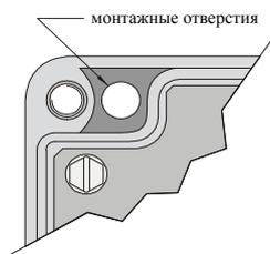
2. Отметьте и просверлите четыре отверстия в монтажной поверхности для четырех винтов (поставляется заказчиком).
