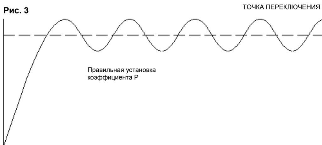
5. После установки коэффициента P, когда колебания выхода BW500 равномерны и погрешность минимальна, выключить ленточный весовой дозатор.
