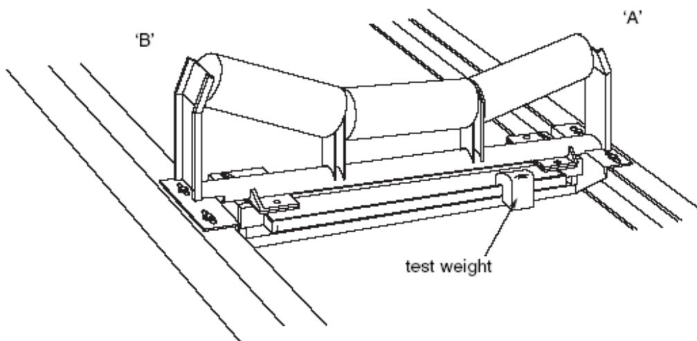
Разместите груз на измерительной ячейке А (как показано на рисунке) и только после этого нажмите клавишу
