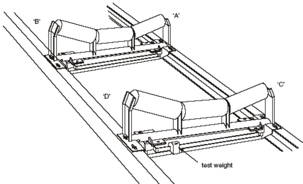
Разместите груз на измерительной ячейке D (как показано на рисунке) и только после этого нажмите клавишу
