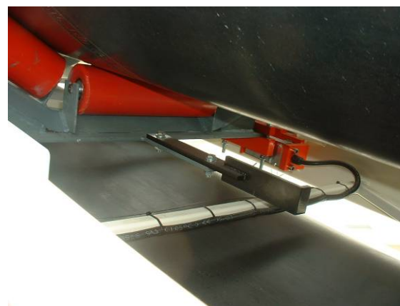
Пластина для крепления калибровочных грузов
